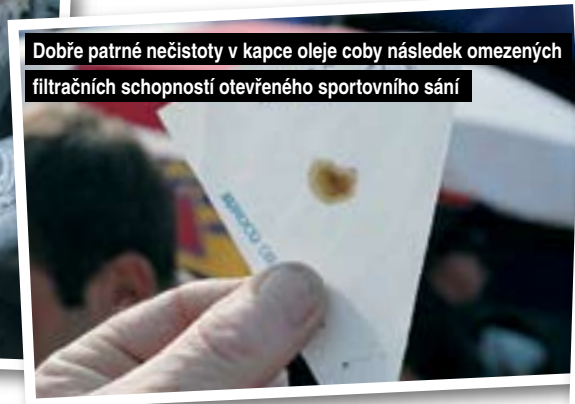
Barva opotřebeného oleje z benzínového motoru
